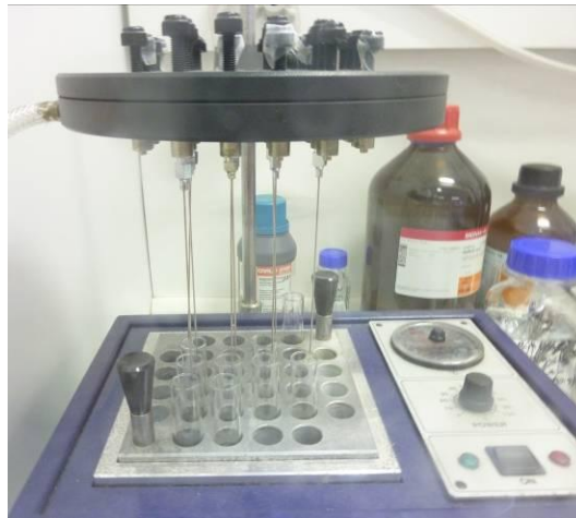
Fig.7 : Evaporation à l'azote
