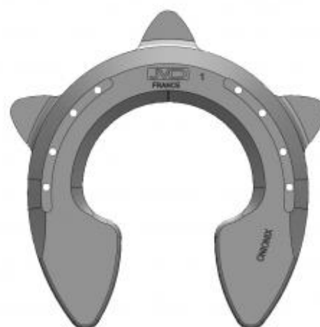
Figure 45 : Tournure antérieure d'un fer en aluminium JMD Onionix® : la couverture des éponges est élargie pour diminuer l'enfoncement des talons. Rolling associé en pince.
