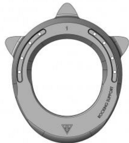
Figure 43 : Tournure antérieure d'un fer en aluminium Rocking Support® de Michel Vaillant : rocking (biseau postérieur) et rolling (biseau antérieur).
