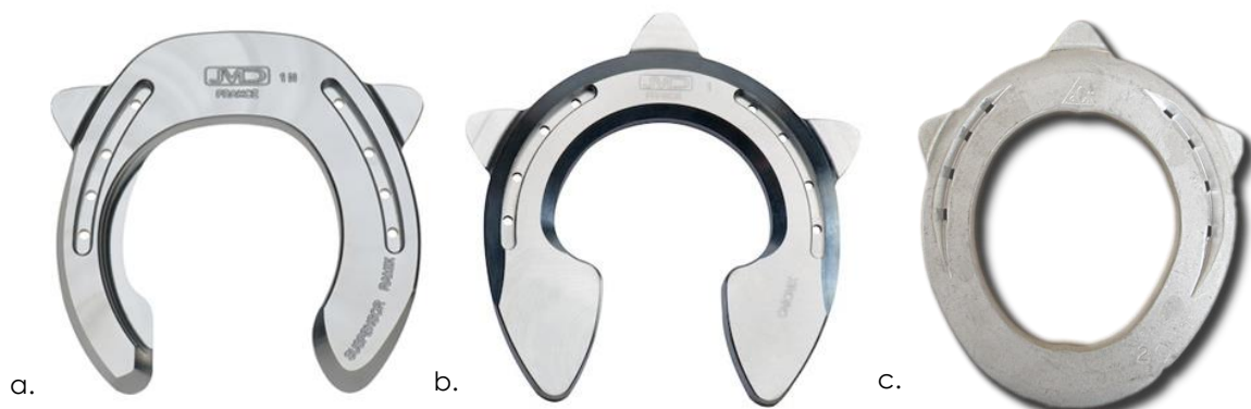
Fig. 12 : Quelques exemples de fers orthopédiques couramment utilisés aujourd'hui. Extrait du catalogue Michel Vaillant gamme MV& JMD et du catalogue ACR. a. Fer asymétrique, pince couverte et éponges biseautées (atteinte de l'une des branches du LSB) b. Fer « à oignons » dont la couverture est élargie en talons (soulagement de l'appareil podotrochléaire) c. Fer en œuf (pathologie du tendon fléchisseur profond et de la bride carpienne, soulagement de l'appareil podotrochléaire).
