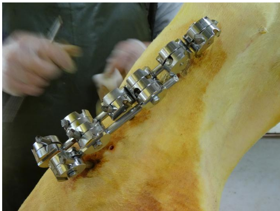
Figure 22 : Montage de type JAM sur un tibia de veau de 150kg (broches de 6 mm et barres de 8 mm).
