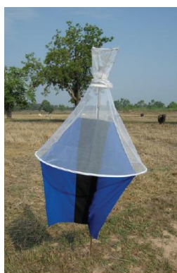
Figure 43 : Piège de type Vavoua d'après Desquesnes (10)
