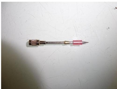
**Figure 6** - Photo d'une aiguille équipée d'un obturateur en plastique souple (photo personnelle)
