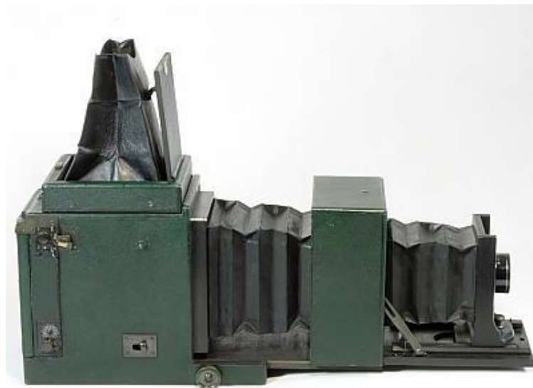
Figure 3 : "Birdland Reflex", modèle de 1910, conçu par Olivier Pike, pour les photographies d'histoire naturelle. D'après « Birdland Reflex - Antique and Vintage Cameras ».
