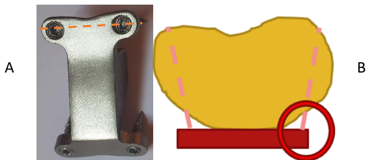
Figure 81 : Illustration du déport des vis et des risques engendrés
