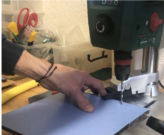
Figure 34 : forage de la plaque stratifié compact à l'aide d'une perceuse à colonne
