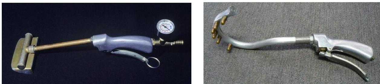
Figure 7 : Lances de pulvérisation de type « dutjet wand » (à gauche) et « sickle wand » (à droite)
