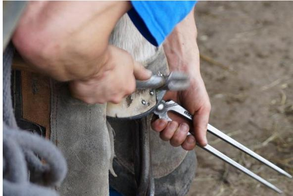
Figure 16 : Rivetage (photographie : M.C.)
