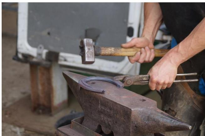
Figure 14 : Ajustement du fer à chaud sur l'enclume (photographie M.C.)
