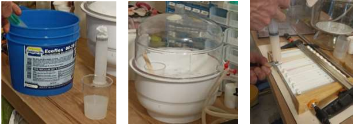
Figure 39 – Etapes de fabrication du silicone, de débullage et de remplissage des moules
