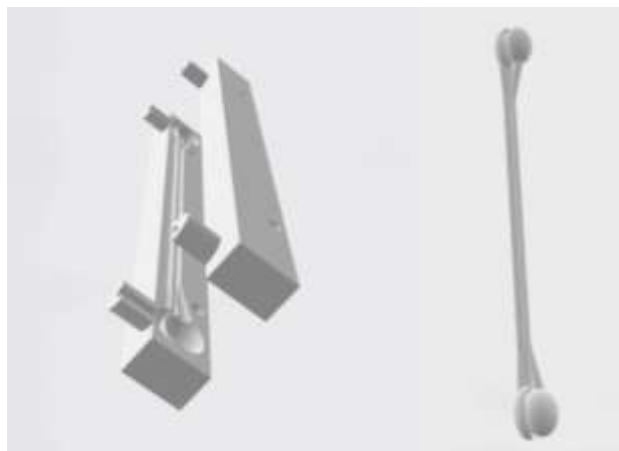
Figure 38 – Aperçu des moules et de la pièce en silicone représentant les testicules et leur cordon spermatique
