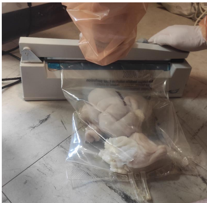
Figure 29 : Photo d'une sertisseuse (à gauche) et de son utilisation pour fermer une poche (à droite). (Source : N. PERRET et A. PRE)
