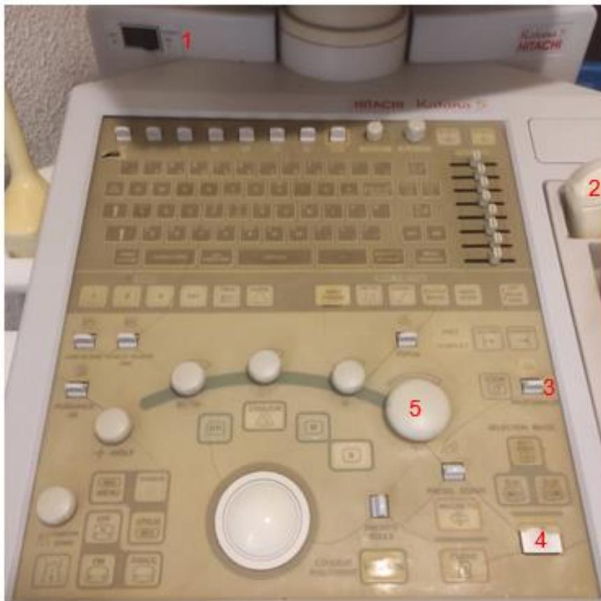
Clavier de l'échographe présent en salle de simulation. 1 : interrupteur marche/arrêt ; 2 : sonde convexe ; 3 : curseur de zoom ; 4 : bouton freeze ; 5 : curseur de contraste.
