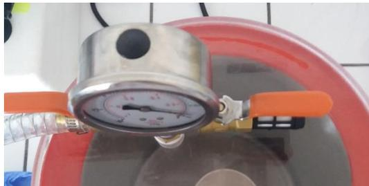
Photo 2: Position du robinet de la chambre à vide (fermé, entrouvert, ouvert)
