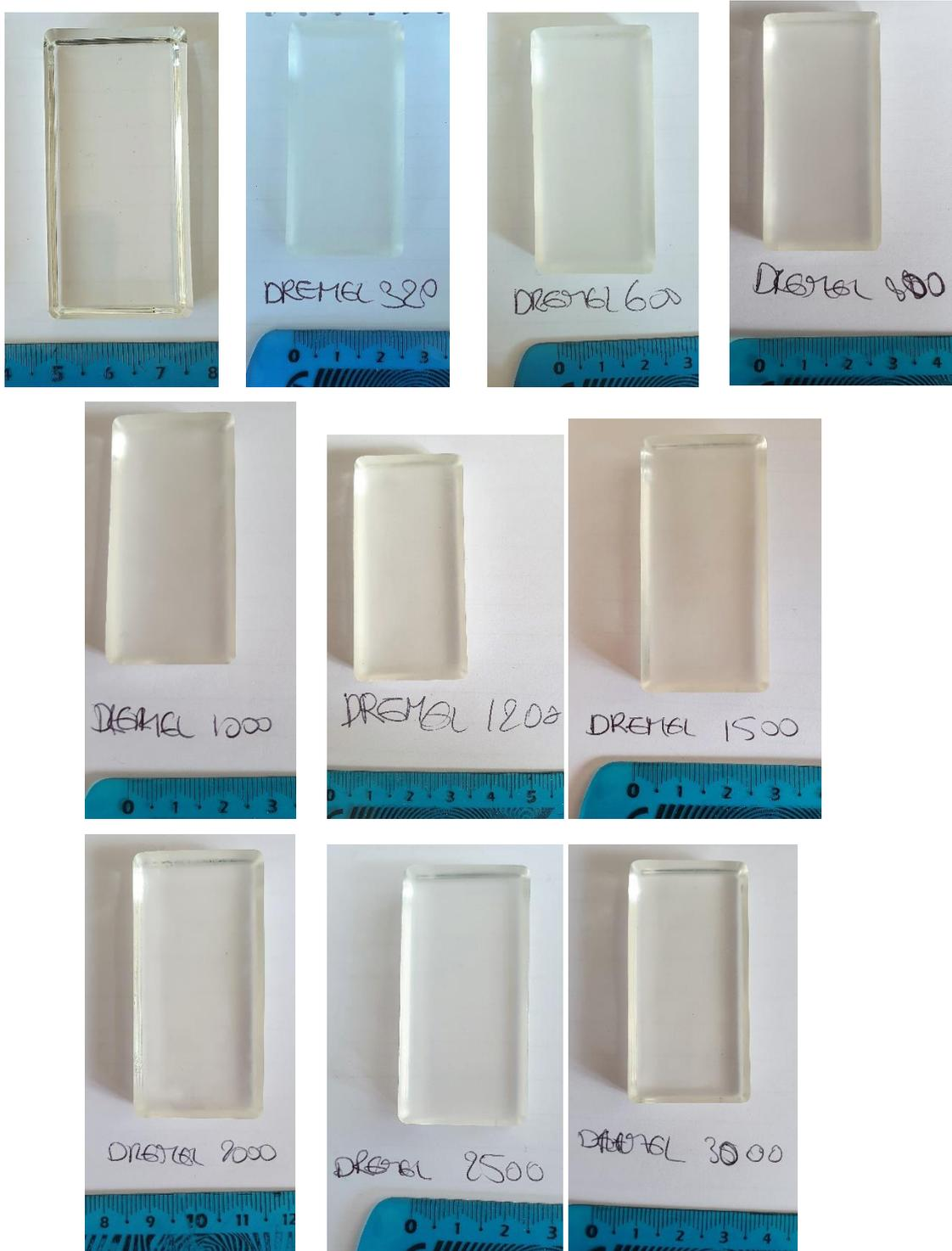
Figure 41 : Photos des différentes étapes du ponçage de la face supérieure d'une coulée de résine
