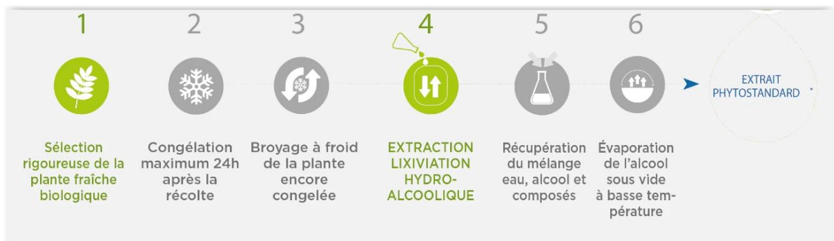
Figure 19 : Procédé d'extraction phytostandard (101)
