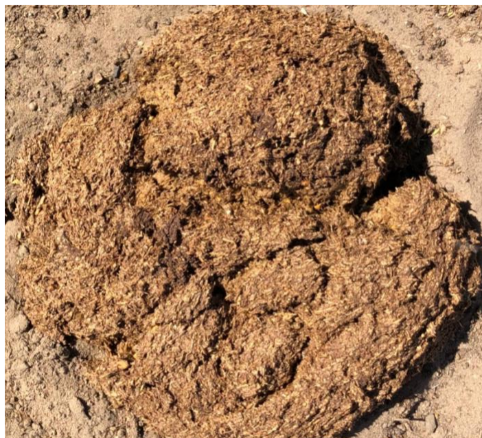
Figure 32 : Fèces de cheval sur un chantier de Rufisque montrant de nombreux éléments non digérés. (Source : P. Lejosne)
