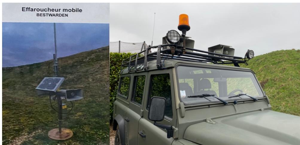
*Figure 19 : Effaroucheur mobile (à gauche) et effaroucheur embarqué sur un véhicule (à droite)
