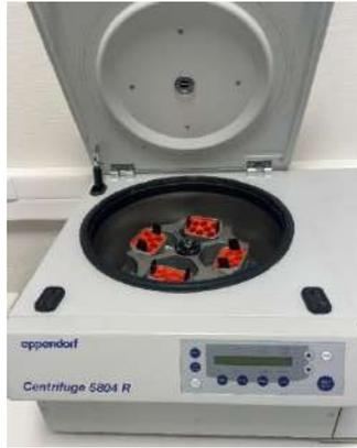
Figure 17 : Centrifugation des tubes 10 minutes à 25000 m.s-2
