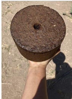
Figure 10 : Bloc après séchage. Source personnelle
