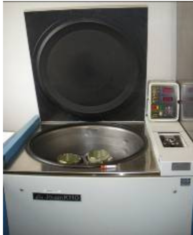
Figure 19 : Centrifugeuse sur pied utilisée au SIAMU pour la séparation du plasma et du concentré globulaire
