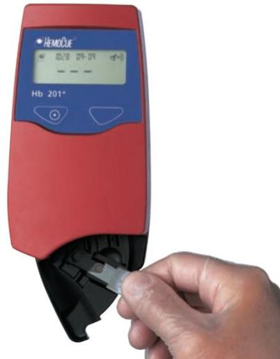
Figure 45 : exemple d'hémoglobinomètre, l'analyseur HemoCue Hb 201+, utilisé pour la mesure de la concentration en hémoglobine (Estridge and Reynolds, 2012)
