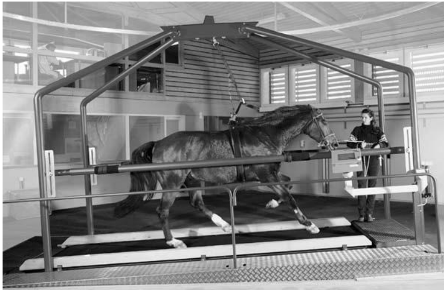
Fig. 84 : Exemple de tapis roulant utilisé dans l'évaluation des performances sportives du cheval. Odyssey Performance Trainer, page consultée le 27/12/2002
